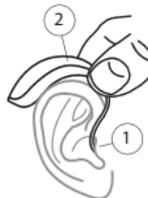
1. Halten Sie das untere Ende des Schlauchs/der Hörerzuleitung fest, während Sie das Ohrstück in das Ohr einsetzen. Es kann beim Einsetzen des Ohrstücks helfen, die Ohrmuschel hoch und nach hinten zu ziehen.
