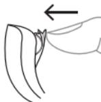
Um das Hörsystem einzuschalten, schließen Sie das Batteriefach. Das Hörsystem bestätigt durch ein akustisches Signal, dass es eingeschaltet ist, sofern Ihr Hörgeräte-Akustiker diese Funktion nicht deaktiviert hat.
