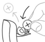
Entfernen Sie den Klebestreifen von der neuen Batterie und stellen Sie sicher, dass kein Kleber zurückbleibt. Lassen Sie die Batterie 60 Sekunden „atmen“.
