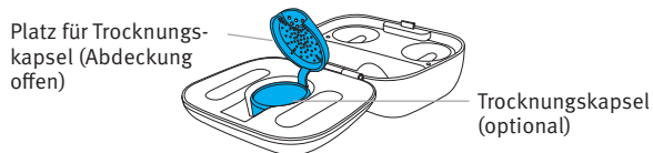
Ladeschale für Hörgeräte mit links/rechts Anzeigen
