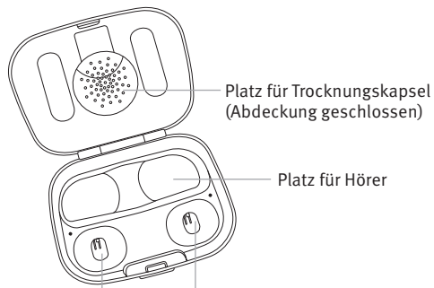
Ladeschale für Hörgeräte mit links/rechts Anzeigen
