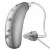
Reinigen Sie die Domes täglich mit einem feuchten Tuch. Achten Sie darauf, dass kein Wasser an oder in das Hörgerät gelangt.
