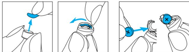
1. Entfernen Sie die Schutzfolie der neuen Batterie und warten Sie zwei Minuten.
