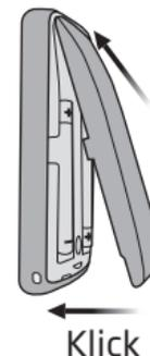
Setzen Sie die Batterieabdeckung wieder ein. Schließen Sie sie, indem Sie sie vorsichtig drücken, bis sich das Batteriefach mit einem Klick schließt.
