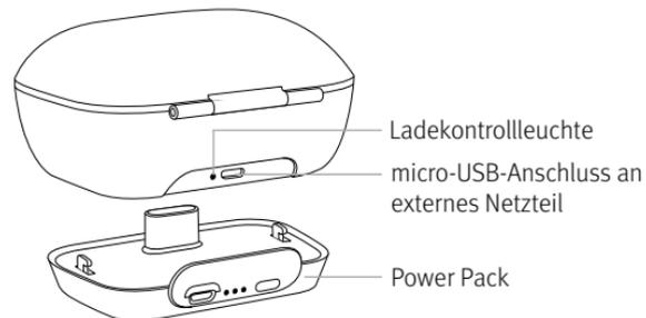
micro-USB-Anschluss an externes Netzteil
