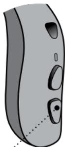
Zum Aktivieren und Deaktivieren des Flugmodus halten Sie die untere Programmtaste für 7 Sekunden lang gedrückt.
