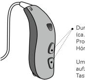
Durch langes Drücken (ca. vier Sekunden) einer der Programmtasten wird das Hörgerät stumm geschaltet.
