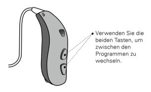
Sie können fortlaufend die Programme in der festgelegten Reihenfolge aufwärts oder abwärts wechseln. Wenn Sie beispielsweise von Programm 1 zu Programm 4 wechseln möchten, können Sie ein Mal die untere Taste drücken, anstelle drei Mal die obere Taste zu verwenden.
