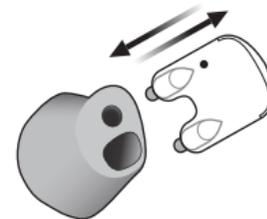
Drücken Sie den neuen Filter, der auf dem anderen Stift sitzt, in die Öffnung ein. Entfernen Sie das Werkzeug durch vorsichtiges Drehen vom Filter. Der neue Filter verbleibt im Hörsystem. Entsorgen Sie das gebrauchte Werkzeug.
