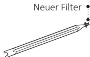
Nehmen Sie das Werkzeug aus der Verpackung. Das eine Ende dient zum Entfernen des alten Mikrofonschutzes. Das andere Ende ist bestückt mit einem neuen Mikrofonschutz (T-Cap).
