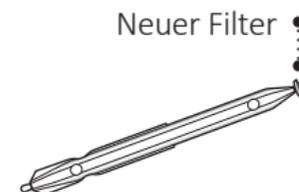
Nehmen Sie das Werkzeug aus der Verpackung. Das eine Ende dient zum Entfernen des alten Mikrofonschutzes. Das andere Ende ist bestückt mit einem neuen Mikrofonschutz (O-Cap).
