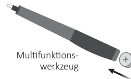
Zum Wechseln der Batterie kann das Multifunktionswerkzeug verwendet werden. Dieses hat ein magnetisches Ende, um die Batterien zu entnehmen oder einzusetzen.
