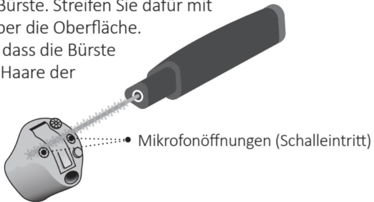
Reinigen Sie eine größere Belüftungsbohrung (und nur diese!), indem Sie die Bürste in die Bohrung drücken und leicht hin- und her bewegen. Stecken Sie die Bürste keinesfalls in den Schallaustritt!
