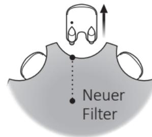
Nehmen Sie das kleine Werkzeug aus der Halterung. Das Werkzeug hat zwei Stifte, einen leeren zum Herausnehmen des alten Cerumenschutzes und einen mit dem neuen ProWax-Cerumenschutzsystem.
