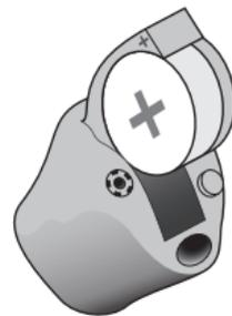
Setzen Sie die neue Batterie in das Batteriefach ein. Achten Sie darauf, dass die „+“-Zeichen auf Batterie und Batteriefach in eine Richtung zeigen.
