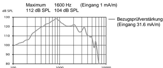
Messungen von digitalen Hörsystemen mit Sinustönen können einen welligen Frequenzgang zur Folge haben. Dieses Artefakt ist auf die Verwendung eines schmalbandigen Eingangssignals zurückzuführen und spiegelt nicht die tatsächliche Leistung bei breitbandigen Eingangssignalen wider.
