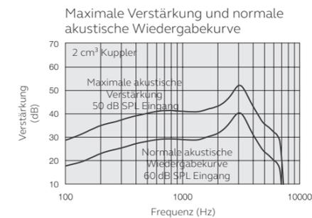
Gemessen nach IEC60118-0 Ausgabe 3.0 2015-06 bei 1.3 V, Impedanz 6.2 Ohm und 23°C an 2cc Kuppler. bzw. an 2cc Entsprechend IEC60118-7 zweite Ausgabe 2005-10 und ANSI/ASA S3.22-2009 (HFA Mittelwert berechnet bei 1000 Hz, 1600 Hz und 2500 Hz; 0 dB SPL Schalldruck gleich 20µPa). Alle Messungen ohne aktiviertes DSP, sofern nicht anders angegeben Messungen nach O.E.S. entsprechend IEC711 1981 Entsprechend IEC60118-0 Ausgabe 2 1983 und Nachtrag 1 1994.
