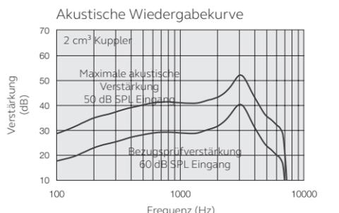
Gemessen nach IEC60118-0 Edition 3.0 2015-06 bei 1,3 V, Impedanz 6,2 Ohm und 23 °C am 2 cm³ Kuppler. Reaktion am 2 cm³ Kuppler nach IEC60118-7 Edition 2 2005-10 und ANSI/ASA S3.22-2009 (HFA-Mittelwert berechnet bei 1000 Hz, 1600 Hz und 2500 Hz; 0 dB SPL Schalldruck gleich 20 µPa). Alle Messungen ohne aktiviertes DSP, sofern nicht anders angegeben. Gemessen am O.E.S. nach IEC711 1981 Nach IEC60118-0 Edition 2 1983 und Zusatz 1 1994.
