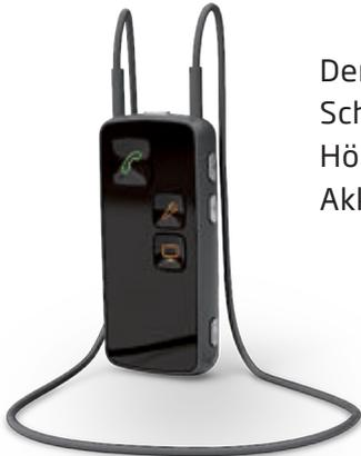
Der **Streamer Pro** ist das Herzstück von ConnectLine: Fernbedienung und Bluetooth-Schnittstelle in einem. Er überträgt die Signale externer Schallquellen drahtlos in die Hörsysteme - und steuert bis zu fünf gekoppelte Geräte gleichzeitig bei einer langen Akku-Laufzeit von bis zu 10 Stunden.
