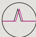
Die **Frequenzverschiebung** dekorreliert Mikrofon- und Lautsprechersignal und verhindert so, dass die Signale sich zu einer Rückkopplung aufschaukeln.
