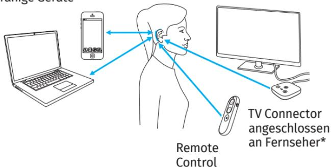
\* Der TV Connector kann an eine beliebige Audioquelle angeschlossen werden, z. B. an einen Fernseher, einen PC oder ein Hi-Fi-System.
