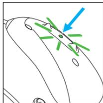
Das Hörgerät ist so konfiguriert, dass es sich nach der Entnahme aus der Ladestation automatisch einschaltet. Ist diese Funktion nicht konfiguriert, drücken Sie 3 Sekunden lang etwas fester
